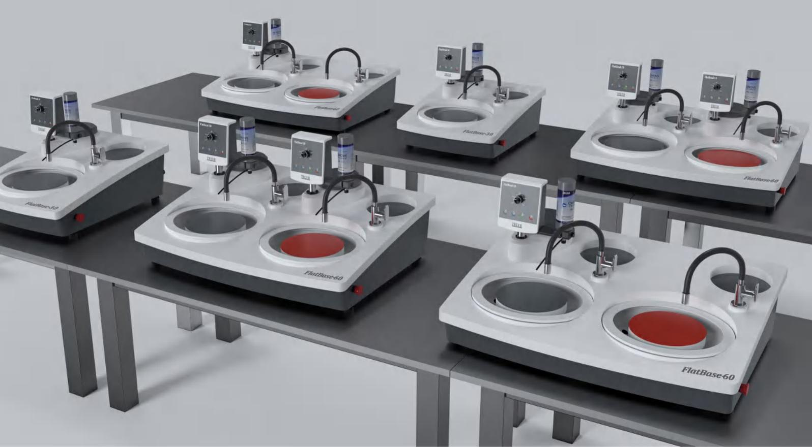
FlatSystem 是川禾 Truer 研发的一款组合菜单式磨抛机，其搭配的 FlatHead-10 控制器主要针对不同材料的可靠而快速的手动研磨抛光而设计。坚固可靠的 FlatSystem 耐用性极佳。加厚设计的全铝下转盘，经典的锥形底座。设备拥有强大的适应性和灵活性，能够根据您不断变化的制样需求，未来可进行半自动 / 自动的升级改造，帮您实现更快速更可靠的样品制备。
